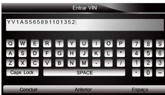
Figura 4-7 Exemplo da Tela de Entrada do VIN Manualmente com Teclado
