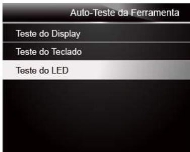
Figura 7-22 Exemplo da Tela Auto-Teste da Ferramenta
