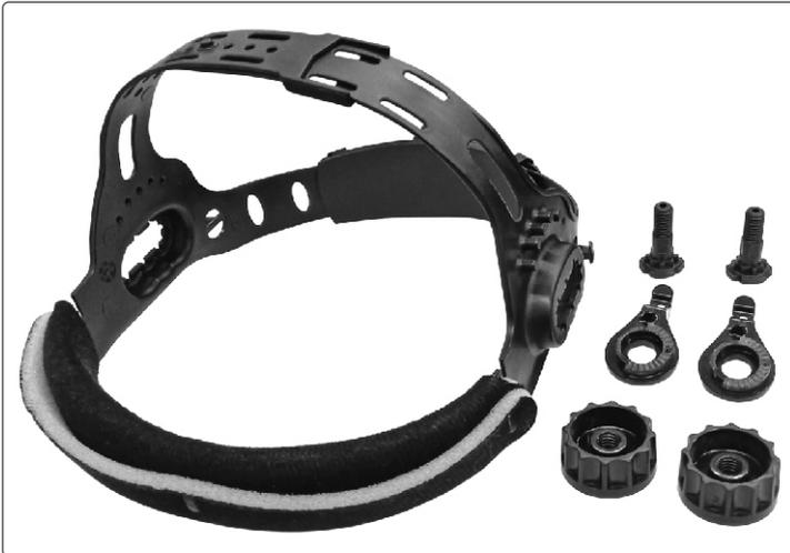
Para instalar a carneira o processo é bem simples. Primeiramente insira o parafuso em um dos orifícios laterais do apoio de cabeça ajustável pelo lado de dentro (fig. 1 e 2). Em seguida, pelo lado de fora, insira um dos reguladores de inclinação (fig.3). Após isso, transpasse o parafuso em um dos orifícios do capacete e rosqueie um dos botões giratórios de aperto (fig.4).
