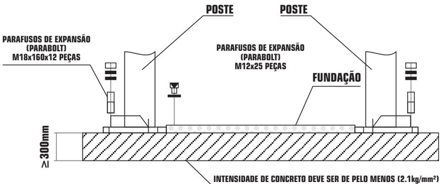
SE FOR USADA UMA FUNDAÇÃO ESPECIAL A INTENSIDADE DO CONCRETO DEVE SER MAIOR QUE 2200PSI (1.54kg/mm<sup>2</sup>)
