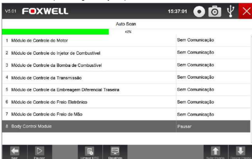
Figura 4-10 Exemplo da Tela Auto Scan do Sistema 3. No final da digitalização do controlador automático com sucesso, um menu com uma lista de controladores instalados juntamente com a visão panorâmica do DTC será exibida.
