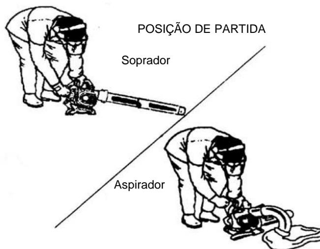
**AVISO:** ao ligar o motor, segure o equipamento conforme a ilustração. Não coloque o equipamento sobre qualquer superfície, exceto se for uma área limpa e rígida ao ligar o motor ou enquanto o motor estiver funcionando. Os detritos, como cascalho, areia, poeira, grama etc., podem ser coletados pela entrada de ar e expelidos pela abertura de descarga. Isso causará danos à unidade, à propriedade ou provocará ferimentos graves aos espectadores ou ao operador.
