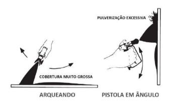
• Sobreposição apropriada (ou padrão de pulverização) é essencial para um acabamento uniforme. Sobreponha cada camada de tinta. Se o operador estiver pulverizando horizontalmente, o operador deve
