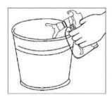
**Nota:** Aterre a pistola de pintura segurando-a contra a borda do recipiente de metal enquanto estiver descarregando fluidos. Não fazer isso pode levar a uma descarga elétrica estática, o que pode causar um incêndio.
