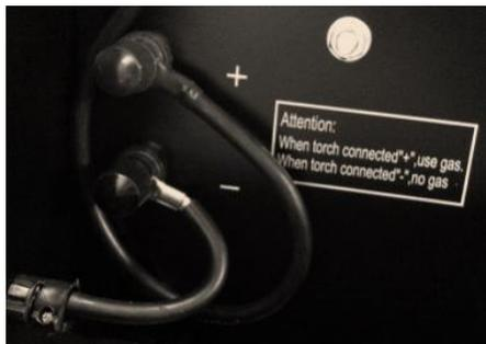
A MÁQUINA DE SOLDA MULTIFUNCIONAL MIG T40I MIG MAG 220V FG4512 FORTG PRO também funciona sem abastecimento de gás, todavia deve-se trocar a posição polar dos conectores na ligação interna do equipamento.
