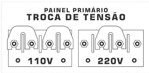
O jumper já vem na posição 220V, como esquema da direita na figura acima. Um jumper a mais acompanha o equipamento caso o usuário deseje alterar a tensão para 110V. **IMPORTANTE:** Desligue a máquina da energia antes de fazer qualquer alteração na tensão de entrada, e tenha certeza ao ligá-la novamente as tensões de entrada e saída são equivalentes. O não cumprimento desse processo e verificação das tensões irá danificar o equipamento permanentemente. A garantia não cobre avaria por mal-uso.
