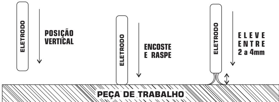
Na soldagem com eletrodo revestido existem três maneiras básicas de se realizar a soldagem.
