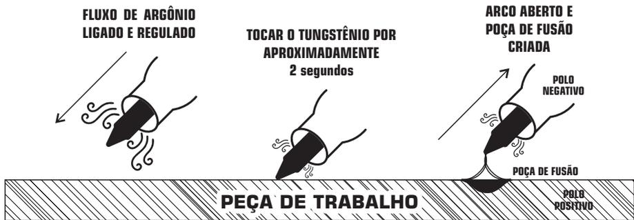
**NOTA:** Na primeira soldagem após a instalação do argônio, é mais seguro, que se espere alguns segundos antes de começar o processo de solda para que o sistema deixe passar (drenar) todo o ar para fora. Quando terminar a soldagem, o argônio ainda fluirá por alguns segundos, a fim de proteger o ponto da soldagem antes de esfriar. Então a tocha deve ser mantida no objeto de soldagem até que o arco seja extinto.
