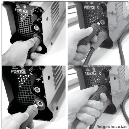
De acordo com a grade de tensão, conecte o cabo de força na caixa de tensão com referência a voltagem da máquina. Verifique para que não haja erros de escolha de tensão imprópria. Após feitos todos esses ajustes, você pode começar a trabalhar com a máquina de solda.
