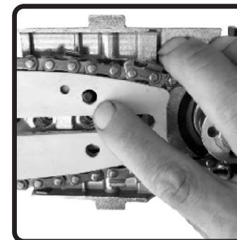
Coloque o sabre no encaixe e ajuste a corrente entre o sabre e o eixo.
