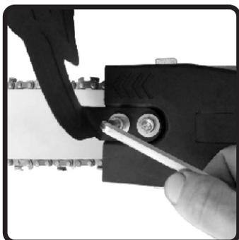
Aperte os parafusos com uma chave hexagonal
