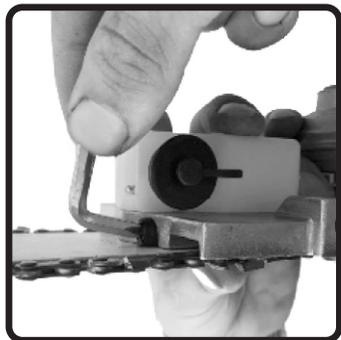
Firme a corrente apertando o parafuso de ajuste
