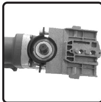
Em seguida, encaixe a sua máquina e termine de parafusar a base ao suporte o suficiente para que a base fique firme no eixo da máquina.
