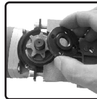
Coloque a engrenagem no eixo e em seguida coloque o flange.
