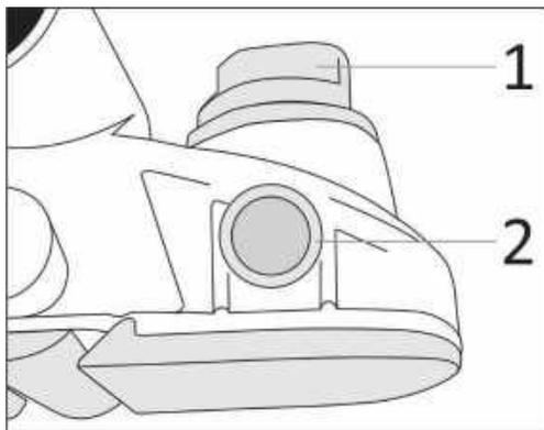
(1): Ponteiro de Ajuste de Profundidade de Corte
