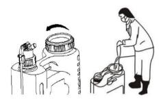
Coloque o pulverizador em suas costas e acione a alavanca para produzir a pressão na câmara antes de prender o gatilho do pulverizador. O ponto ou a pulverização contínua são opcionais.
