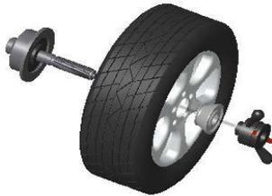
Eixo Principal de Rodas > Coloque a Roda > Insira o cone adequado (cabeça pequena para dentro) > Use o engate rápido para prender tudo no lugar. Não é necessário pressão extrema, isso pode danificar o engate rápido.
