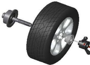
Eixo Principal de Rodas > insira o cone adequado (com a cabeça pequena para dentro) > insira o engate rápido.
