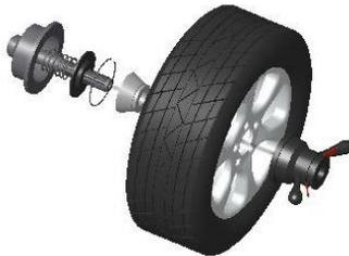
Eixo Principal de Rodas > Insira o cone adequado (cabeça pequena para fora) > Coloque a Roda > O suporte para roda > Por fim o engate rápido para prender tudo no lugar. Não é necessário pressão extrema, isso pode danificar o engate rápido.
