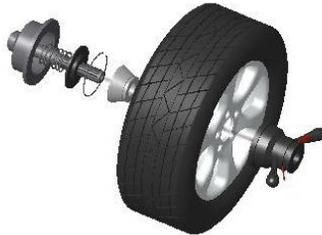
Eixo Principal de Rodas > insira o cone adequado (com a cabeça pequena para fora) > coloque a roda > insira o engate rápido.
