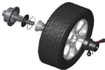
Cone principal do eixo-adequado (cabeça grande para dentro) – roda – porca da alavanca rápida
