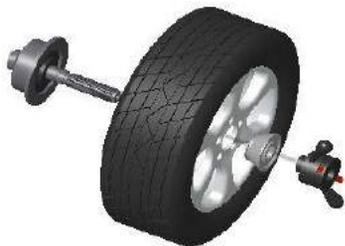
Principal eixo de rodas - cone adequado (cabeça pequena para dentro) – porca da alavanca rápida
