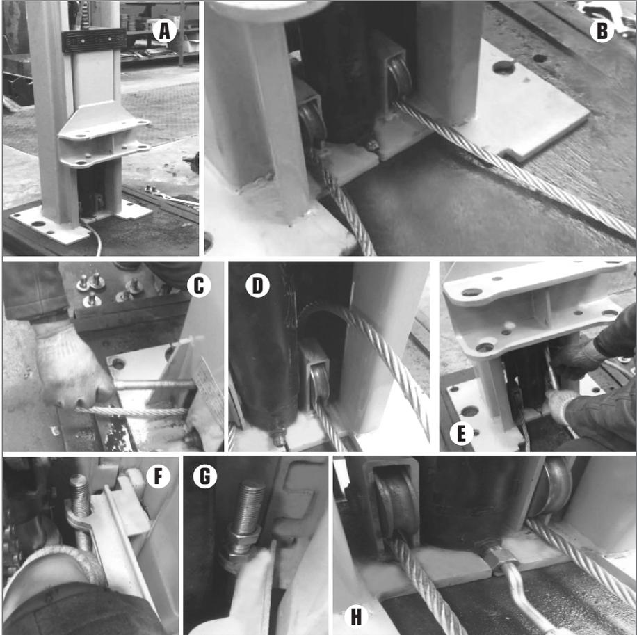
Coloque as colunas e a mesa deslizante de elevação a 400-500mm de altura (A). Instale o cabo (B). Passe-o por trás da coluna (C). Verifique se o cabo está passando corretamente pela roldana (D). Em seguida, posicione o cabo para cima (E). Fixe os parafusos com porcas no orifícios, como na foto (F), lembrando de fazer o mesmo do lado oposto (G). Finalize instalando a tubulação no cilindro (H).
