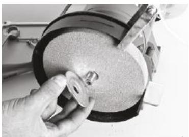
**ATENÇÃO:** Sempre utilizar rebolos com velocidade superior a 4.000r.p.m. - rebolos com capacidade inferior a velocidade nominal do equipamento pode causar acidentes.
