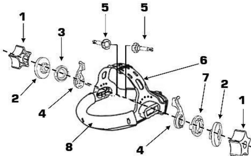
Nota: \*As duas peças de plástico numeradas como "3" e "7", com a mesma aparência, distinguem-se por uma peça da esquerda e uma peça da direita; elas são marcadas com "L" (esquerda) e "R" (direita). Não as misture durante a desmontagem e montagem.
