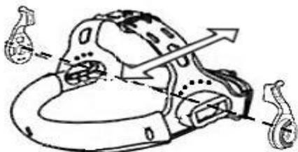
Desaperte as porcas de ambos os lados para ajustar o ângulo vertical da máscara girando para cima ou para baixo. Você pode ouvir o som de um estalo durante o ajuste.
